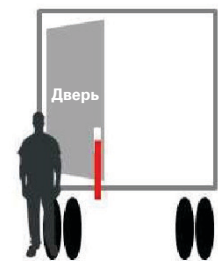
Снять ремень с двери 1. Открыть дверь, потянув на себя, таким образом, чтобы она оставалась между вами и грузовиком. Снять ремень.
