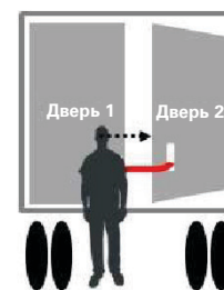
Открыть дверь 2 с прикрепленным ремнем. Проверить наличие наклонного груза ОСТАНОВИТЬ работу, если груз упирается в дверь или наклонен.
